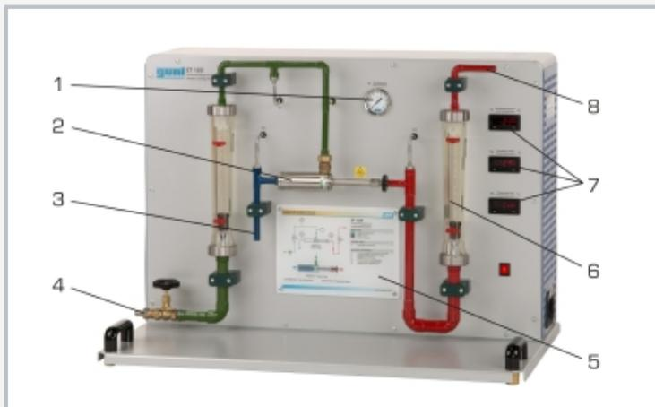
1 manomètre, 2 tube à vortex, 3 sortie d'air froid, 4 raccord d'air comprimé, 5 schéma de processus, 6 débitmètre, 7 affichages de température, 8 sortie d'air chaud
