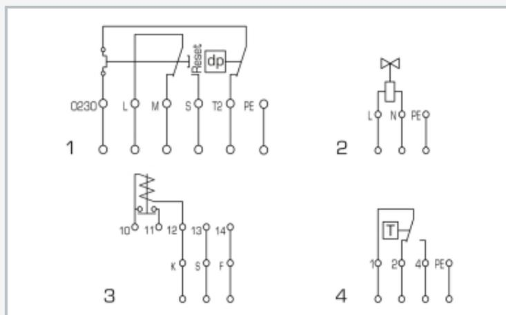
Schémas de connexion: 1 pressostats différentiels, 2 électrovanne, 3 relais de démarrage électromagnétique, 4 thermostat
