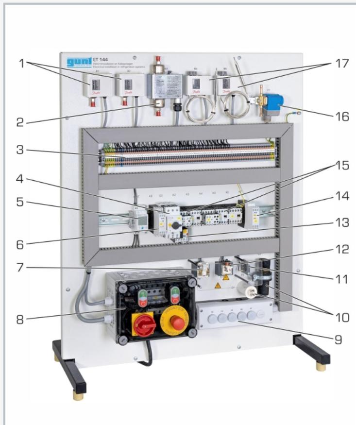
1 pressostat, 2 pressostat différentiel, 3 barrettes à bornes, 4 disjoncteur avec limiteur de courant de démarrage, 5 programmeur, 6 disjoncteur thermistor, 7 relais de démarrage PTC, 8 armoire de commande, 9 lampes, 10 condensateurs, 11 disjoncteur bimétal, 12 relais de démarrage électromagnétique, 13 relais de protection ajustable, 14 relais temporisé, 15 contacteurs, 16 électrovanne, 17 thermostat
