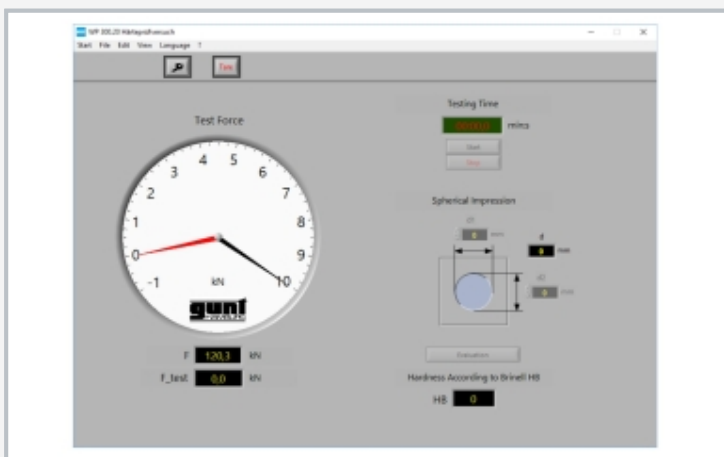
Screenshot der Software: Härteprüfung nach Brinell
