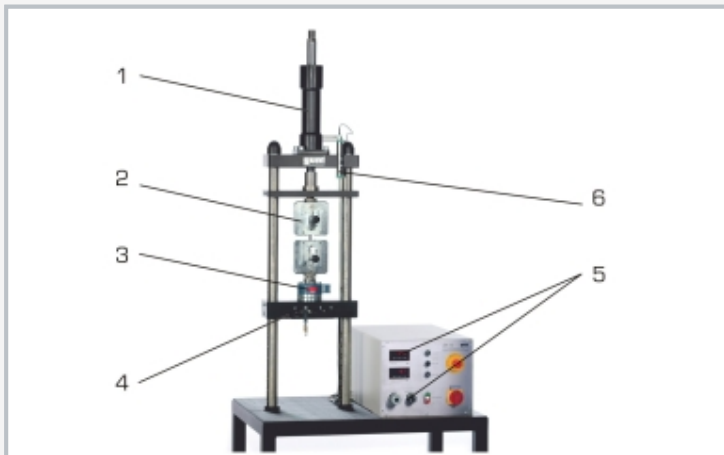
1 Hydraulikzylinder zur Erzeugung von Zug- und Druckkräften, 2 Arbeitsbereich mit dem Zubehör WP 310.05, 3 Kraftaufnehmer, 4 höhenverstellbare untere Traverse mit Verriegelung, 5 Anzeige- und Bedienelemente, 6 Wegaufnehmer
