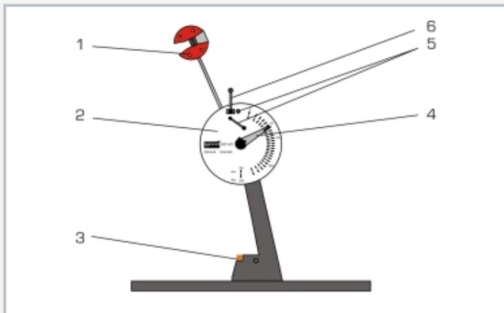
1 mouton avec poids supplémentaires amovibles, 2 échelle, 3 éprouvette de choc, 4 aiguille entraînée, 5 activation à deux mains, 6 frein
