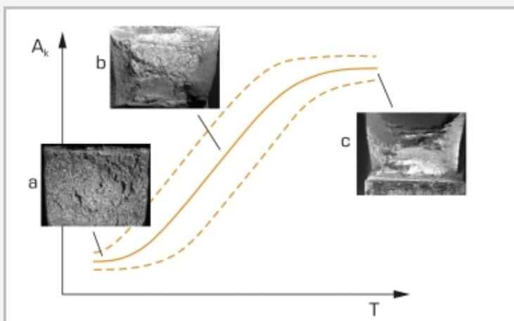
Diagramme énergie de choc-température avec surfaces de rupture typiques: courbe des valeurs moyennes avec zone de distribution,  $A_k$  énergie de choc, T température; a position basse avec rupture ductile ou de fragilité, b zone de transition avec rupture mixte, c position haute avec ruptures ductiles
