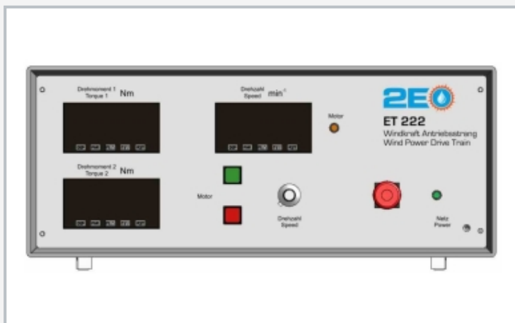
Messverstärker mit Digitalanzeigen und Bedienelementen
