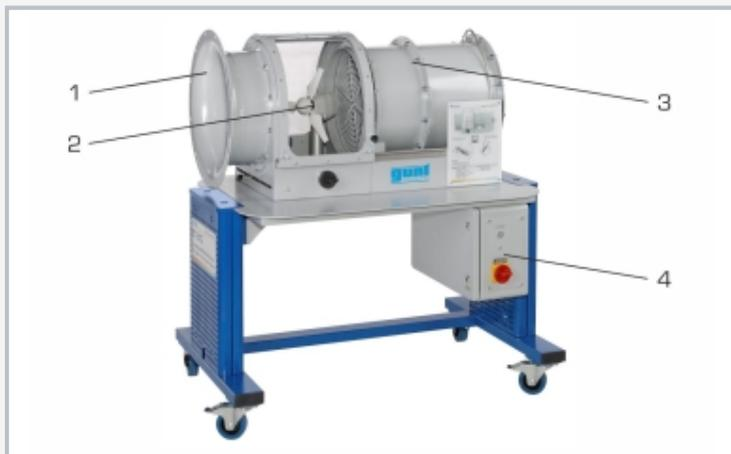
1 contorno de entrada, 2 sección de ensayo, 3 túnel de viento, 4 caja de distribución
