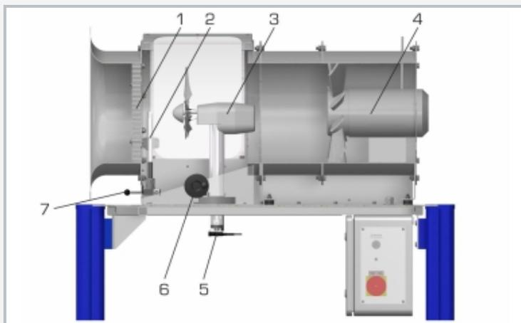
1 rectificador de flujo, 2 sensor de velocidad del viento, 3 central eólica, 4 soplante, 5 sensor de guiñada, 6 volante manual, 7 palanca
