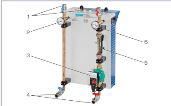
1 avance/retorno ET 352, 2 termómetro retorno, 3 bomba de circulación, 4 avance/retorno HL 313, 5 sensor de caudal, 6 termómetro avance
