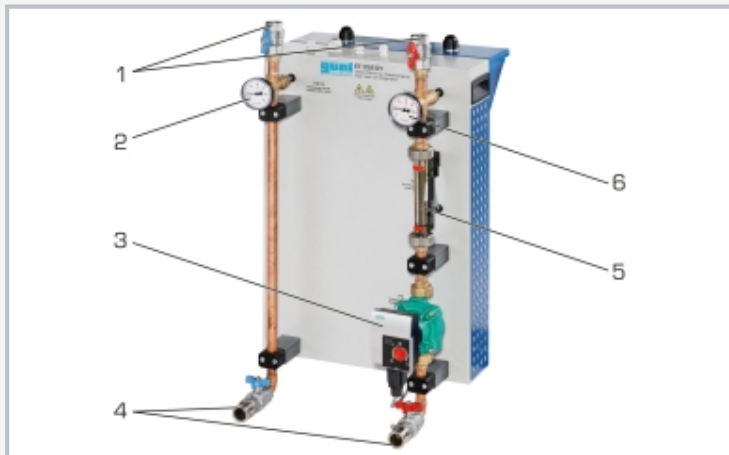
1 Vor-/Rücklauf ET 352, 2 Thermometer Rücklauf, 3 Umwälzpumpe, 4 Vor-/Rücklauf HL 313, 5 Durchflussaufnehmer, 6 Thermometer Vorlauf
