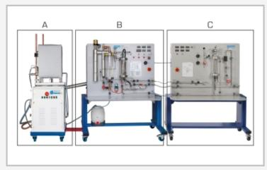
Fonctionnement de l'ET 852 avec la turbine à vapeur ET 851 pour démontrer le principe d'une centrale électrique à vapeur
