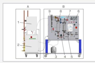
1 réservoir d'alimentation en eau, 2 chaudière, 3 réservoir de stockage avec pompe, 4 pompe à condensat, 5 pompe à jet d'eau, 6 éléments d'affichage et de commande, 7 condenseur, 8 réservoir collecteur du condensat, 9 surchauffeur A unité d'alimentation en vapeur, B traitement ultérieur de vapeur
