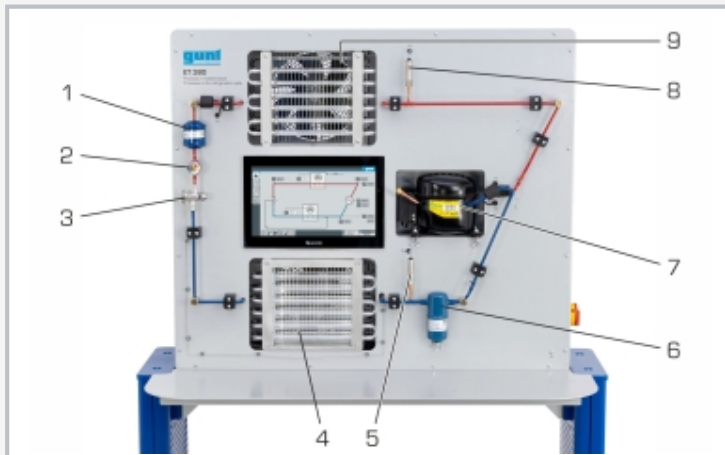
1 Filter/Trockner, 2 Schauglas mit Feuchteindikator, 3 thermostatisches Expansionsventil (TEV), 4 Verdampfer mit Ventilator, 5 Druckaufnehmer (Niederdruck), 6 Flüssigkeitsabscheider, 7 Verdichter, 8 Druckaufnehmer (Hochdruck), 9 Verflüssiger mit Ventilator
