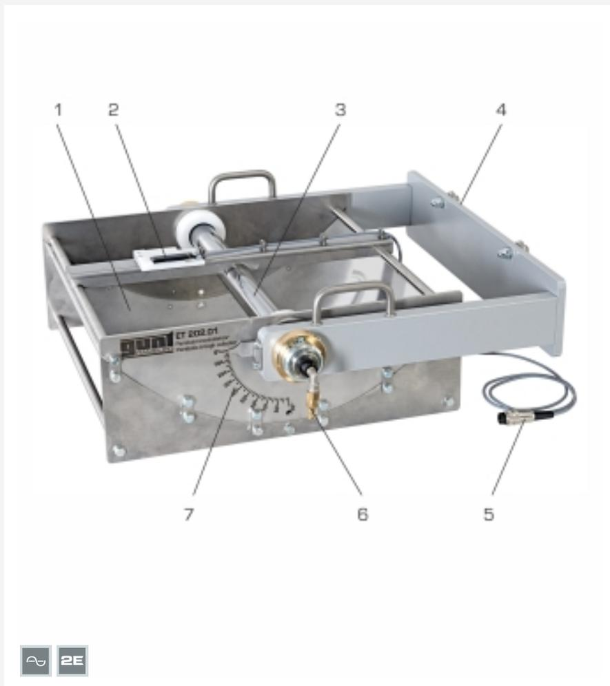
1 espejo cilindro-parabólico, 2 sensor para la iluminancia (volumen de suministro del ET 202), 3 tubo absorbente, 4 suspensión, 5 cable y conexión del sensor (volumen de suministro del ET 202), 6 conexión al circuito solar en ET 202, 7 escala
