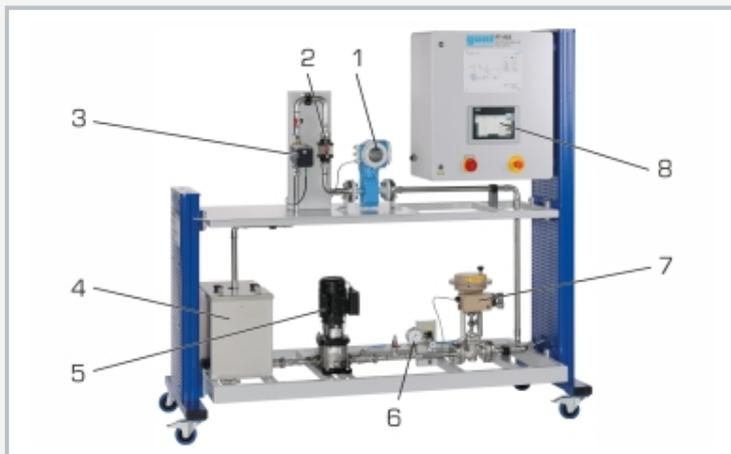
1 capteur de débit intelligent, 2 affichage du débit, 3 vanne proportionnelle à entraînement motorisé, 4 réservoir de stockage, 5 pompe, 6 manomètre, 7 vanne de régulation, 8 écran tactile
