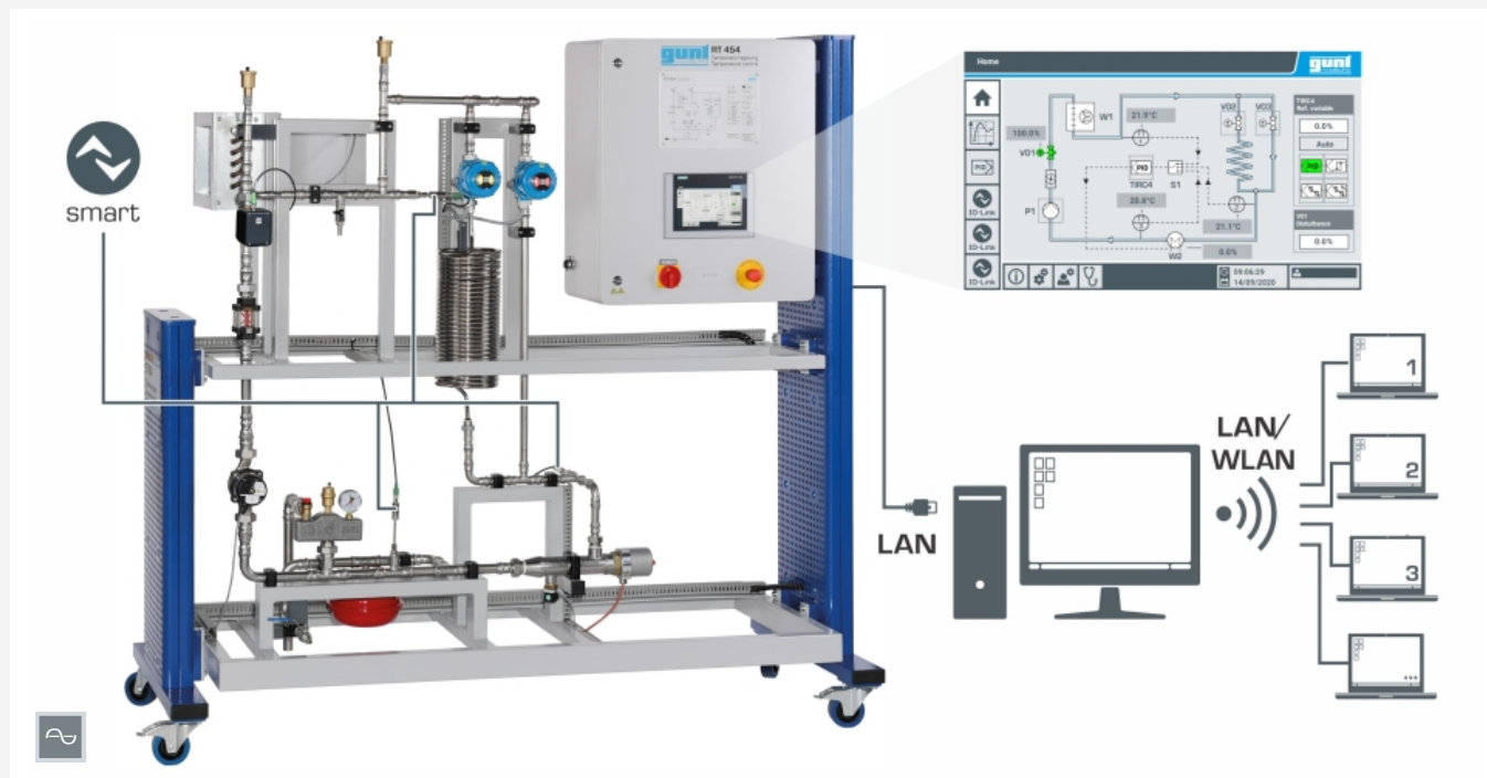
Steuerung und Bedienung über Touchscreen oder einen PC mit GUNT-Software. Beobachtung und Auswertung der Versuche an beliebig vielen Arbeitsplätzen über LAN/WLAN.
