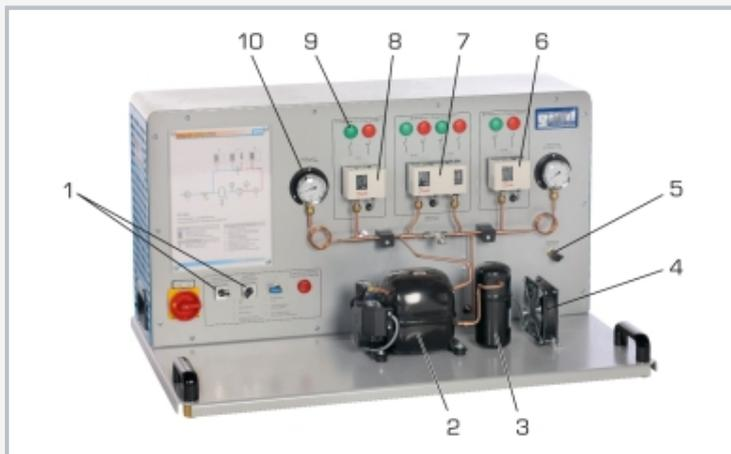
1 éléments de commande, 2 compresseur, 3 réservoir, 4 ventilateur, 5 soupape de dégagement d'air, 6 pressostat haute pression, 7 pressostat combiné, 8 pressostat basse pression, 9 lampes de signalisation d'états de commutation, 10 manomètre
