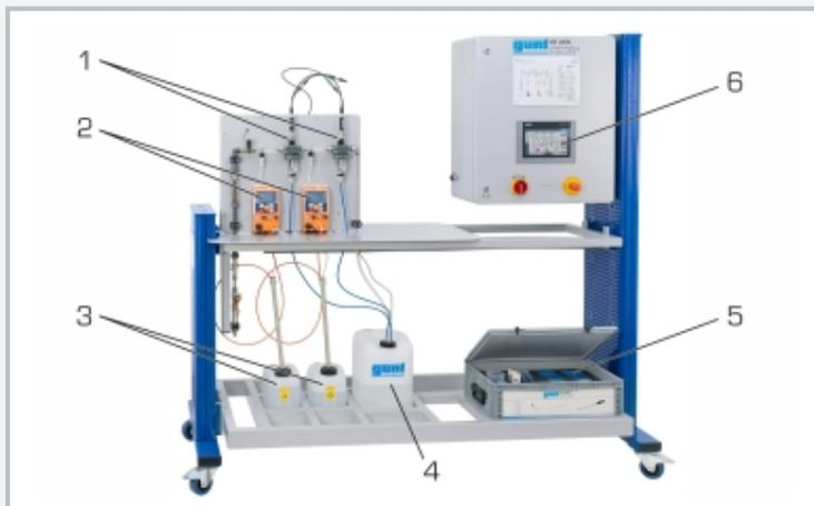
1 capteurs de pH intelligents, 2 pompes de dosage, 3 réservoir de produits chimiques, 4 réservoir de produit, 5 accessoires, 6 écran tactile
