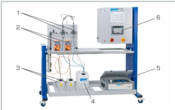
1 smarte pH-Wert-Sensoren, 2 Dosierpumpen, 3 Chemikalienbehälter, 4 Produktbehälter, 5 Zubehör, 6 Touchscreen
