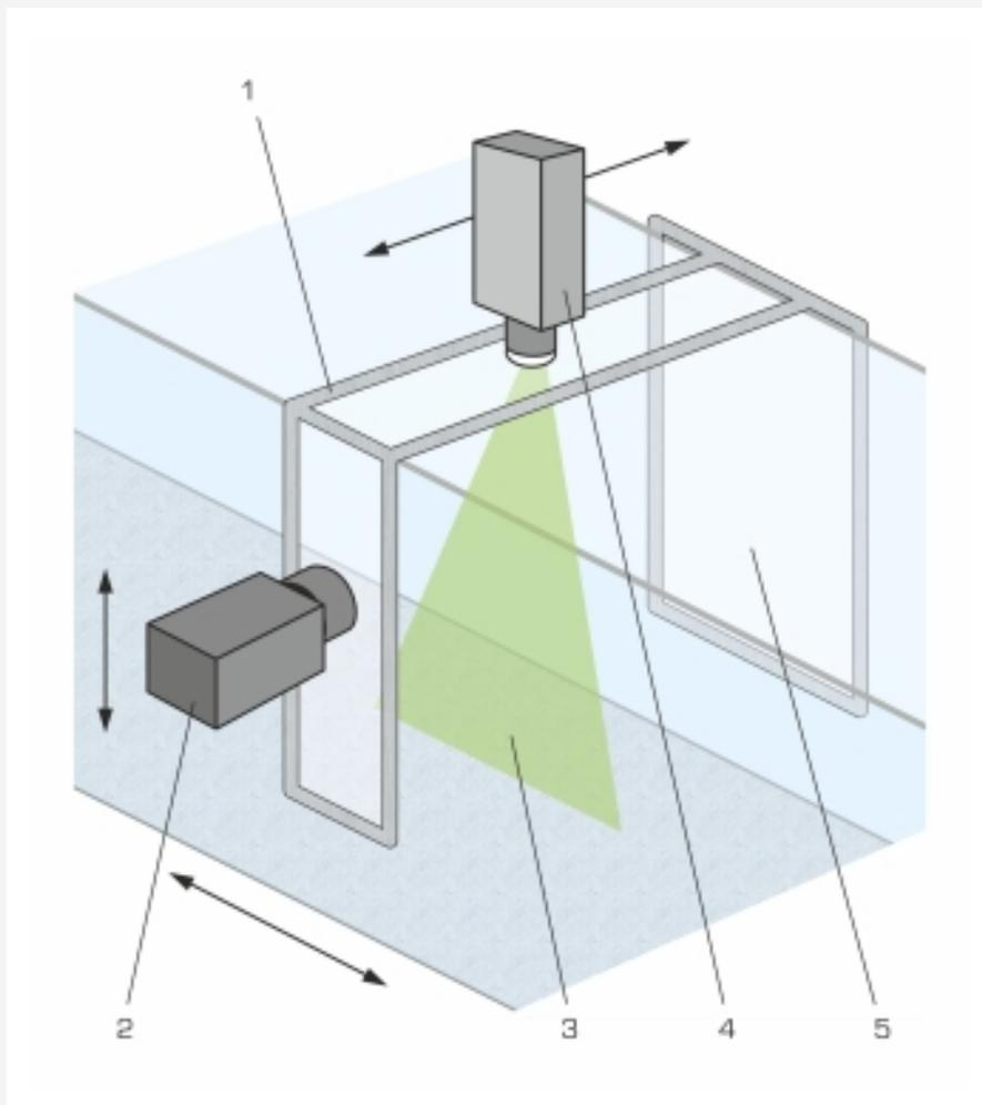
1 support pour instruments, 2 caméra (non incluse), 3 nappe lumineuse, 4 source de lumière (non incluse), 5 plaque comme surface de contraste
