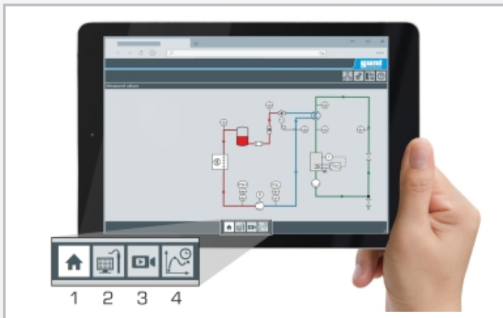
Screenshot der Webbrowser-Darstellung am Beispiel von ET 400: Startbildschirm 1 Startbildschirm mit Prozessschema, 2 aktuelle Messwerte, 3 Livebild, 4 graphische Darstellung der Versuchsergebnisse
