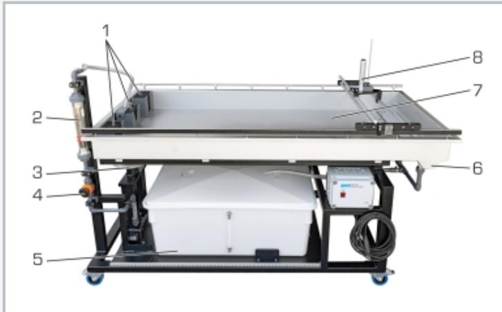
1 Einlaufelemente, 2 Durchflussmesser, 3 Neigungsverstellung, 4 Ventil, 5 Vorratsbehälter, 6 Ablaufelement mit Filter, 7 Versuchsstrecke, 8 Tasteinrichtung
