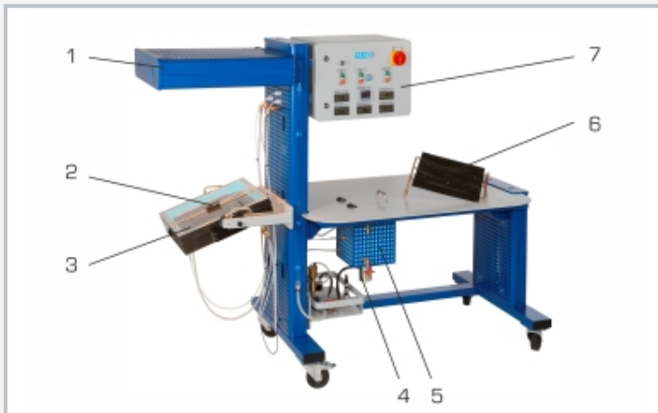
1 module d'éclairage, 2 enregistreur de l'éclairement, 3 capteur solaire réglage en hauteur avec plan inclinable, 4 chauffage électrique supplémentaire, 5 réservoir, 6 absorbeur interchangeable, 7 armoire de distribution
