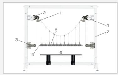
1 mesure d'angle, 2 déviation pour le montage sur l'appui, 3 dispositif de blocage du câble porteur, 4 tiges de rigidification de la route, 5 route avec 11 sections, 6 support pour le tarage et comme aide au montage; accessoires: 7 bâti de montage SE 200, 8 appui SE 200.21
