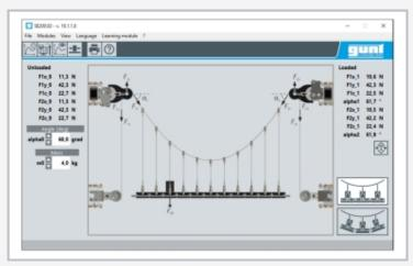
Capture d'écran du logiciel GUNT: affichage des forces des appuis et du câble ainsi que de l'angle du câble porteur sur les appuis
