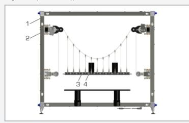
Exemple de montage: 1 bâti de montage SE 200, 2 deux appuis SE 200.21, 3 route rigidifiée, 4 deux charges SE 200.25
