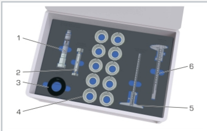
1 Dreipunkt-Innenmessschraube, 2 Grenzlehrdorn, 3 Einstellring, 4 Prüfobjekt (Nabe), 5 Tiefenmessschieber, 6 Messschieber
