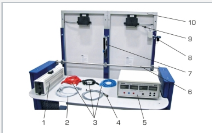
1 Schiebewiderstand, 2 Netzkabel, 3 Kabelsatz für Parallel- und Reihenschaltung, 4 Messkabel, 5 Messverstärker, 6 Kippachse, 7 Neigungsmesser, 8 Beleuchtungsstärkeaufnehmer, 9 Temperatureaufnehmer, 10 Solarmodule
