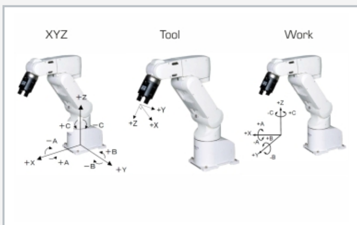
Jog Modi XYZ: système de coordonnées du robot Tool: système de coordonnées de la main Work: système de coordonnées défini par l'utilisateur
