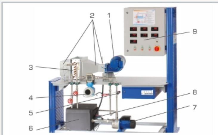
1 ventilateur, 2 conduit d'air avec points de mesure de la température, 3 échangeur de chaleur, 4 débitmètre, 5 capteur de pression, 6 réservoir d'eau, 7 pompe, 8 dispositif de chauffage avec thermostat, 9 éléments d'affichage et de commande
