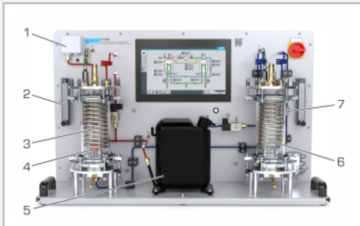
1 Druckschalter, 2 Durchflussmesser, 3 Verflüssiger, 4 Expansionsventil, 5 Verdichter, 6 Verdampfer, 7 Schauglas
