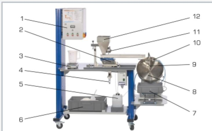
1 armoire de commande, 2 dispositif de dosage de matière solide, 3 balance, 4 soupape de réduction de pression, 5 réservoir de liquide de granulation, 6 réservoir de matière solide, 7 réservoir d'agglomérats, 8 cuve de granulation, 9 racleur, 10 buse bi-composant, 11 vibreur, 12 silo de matière solide
