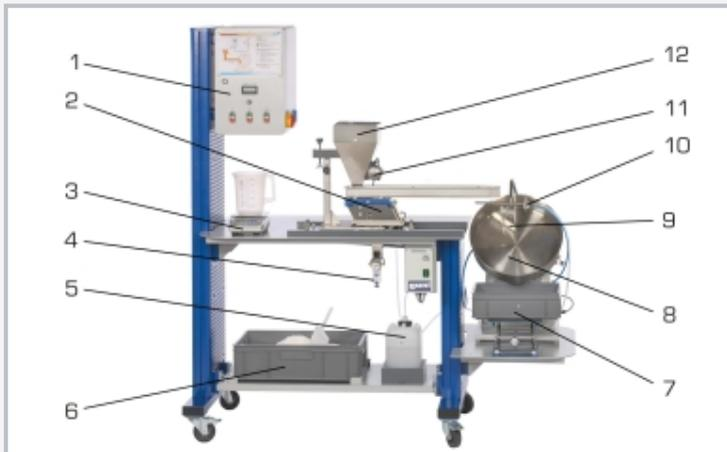
1 Schaltschrank, 2 Feststoff-Dosiereinrichtung, 3 Waage, 4 Druckminderventil, 5 Behälter Granulierflüssigkeit, 6 Behälter Feststoff, 7 Behälter Agglomerate, 8 Granulierteller, 9 Schaber, 10 Zweistoffdüse, 11 Vibrator, 12 Silo Feststoff
