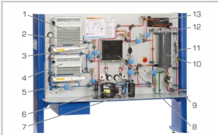
1 évaporateur, 2 soupape de détente, 3 tube capillaire, 4 évaporateur (congélation), 5 régulateur de pression d'évaporation, 6 compresseur, 7 réservoir, 8 échangeur de chaleur avec ventilateur, 9 pompe, 10 réservoir pour mélange d'eau glycolée, 11 débitmètre (eau glycolée), 12 électrovanne, 13 échangeur de chaleur à serpentin
