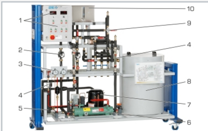
1 Anzeige- und Bedienelemente, 2 Pumpe, 3 Manometer, 4 Durchflussmesser, 5 Verdampfer, 6 Verflüssiger, 7 Verdichter, 8 Eisspeicher, 9 3-Wege-Ventil, 10 Ausgleichsbehälter (Glykol-Wasser-Gemisch)
