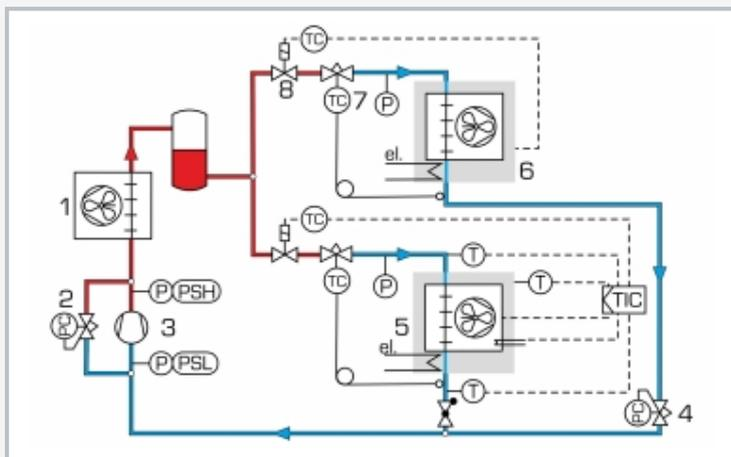
1 condenseur, 2 régulateur de puissance, 3 compresseur, 4 régulateur de pression d'évaporation, 5 chambre de refroidissement avec dispositif de chauffage, ventilateurs, chauffage de dégivrage, 6 chambre de refroidissement avec dispositif de chauffage, ventilateurs, 7 soupape de détente, 8 électrovanne avec thermostat, T température, P pression; PSH, PSL pressostat, TIC régulateur de réfrigération
