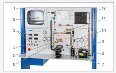
1 soupape de détente, 2 chambre de réfroidissement, 3 éléments d'affichage et de commande, 4 pressostat, 5 injecteur, 6 injecteur de refroidissement, 7 compresseur BP, 8 compresseur HP, 9 réservoir, 10 débitmètre, 11 échangeur de chaleur, 12 condenseur
