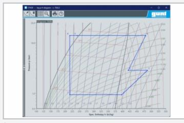
Capture d'écran du logiciel dans un processus réel de l'installation 1-2 compression BP, 2-3 refroidissement intermédiaire, 3-4 compression HP, 4-5 condensation, 5-6 surrefroidissement, 6-7 expansion, 7-1 évaporation
