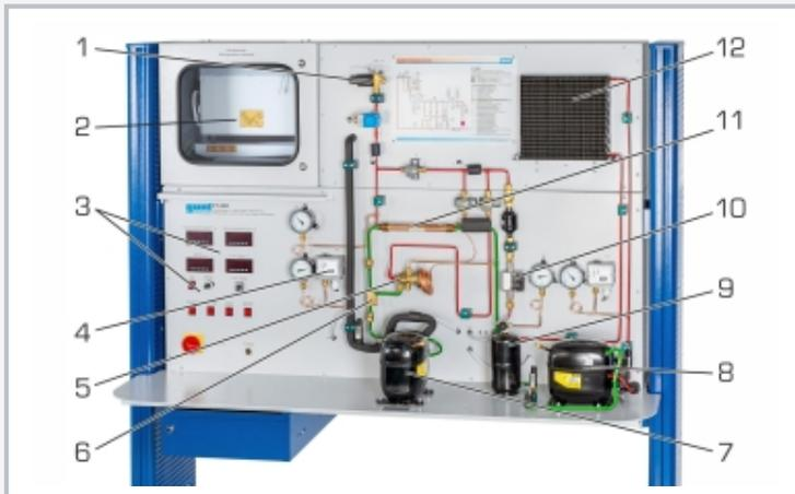
1 Expansionsventil, 2 Kühlkammer, 3 Anzeige- und Bedienelemente, 4 Druckschalter, 5 Einspritzventil, 6 Einspritzkühler, 7 ND-Verdichter, 8 HD-Verdichter, 9 Sammler, 10 Durchflussmesser, 11 Wärmeübertrager, 12 Verflüssiger
