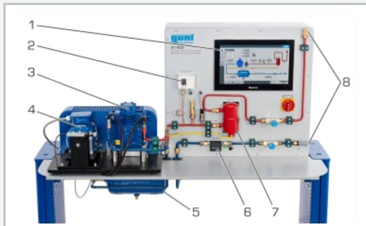
1 API avec panneau tactile, 2 pressostat, 3 compresseur de l'agent réfrigérant, 4 moteur d'entraînement avec mesure du couple, 5 réservoir de stabilisation, 6 débitmètre, 7 séparateur d'huile, 8 silencieux
