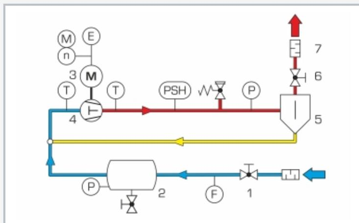
1 vanne côté aspiration, 2 réservoir de stabilisation, 3 moteur d'entraînement, 4 compresseur, 5 séparateur d'huile, 6 vanne côté pression, 7 silencieux; F débit, T température, P pression, M couple, n vitesse de rotation, E puissance électrique; PSH pressostat; bleu: basse pression, rouge: haute pression, jaune: retour d'huile
