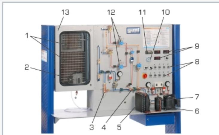
1 évaporateur, 2 humidificateur, 3 régulateur de pression d'évaporation, 4 échangeur de chaleur, 5 groupe frigorifique, 6 réservoir, 7 compresseur, 8 éléments de commande, 9 affichages de température et d'humidité, 10 horloge de commutation de dégivrage, 11 régulation du ventilateur, 12 électrovanne permettant de sélectionner l'évaporateur, 13 chambre de refroidissement
