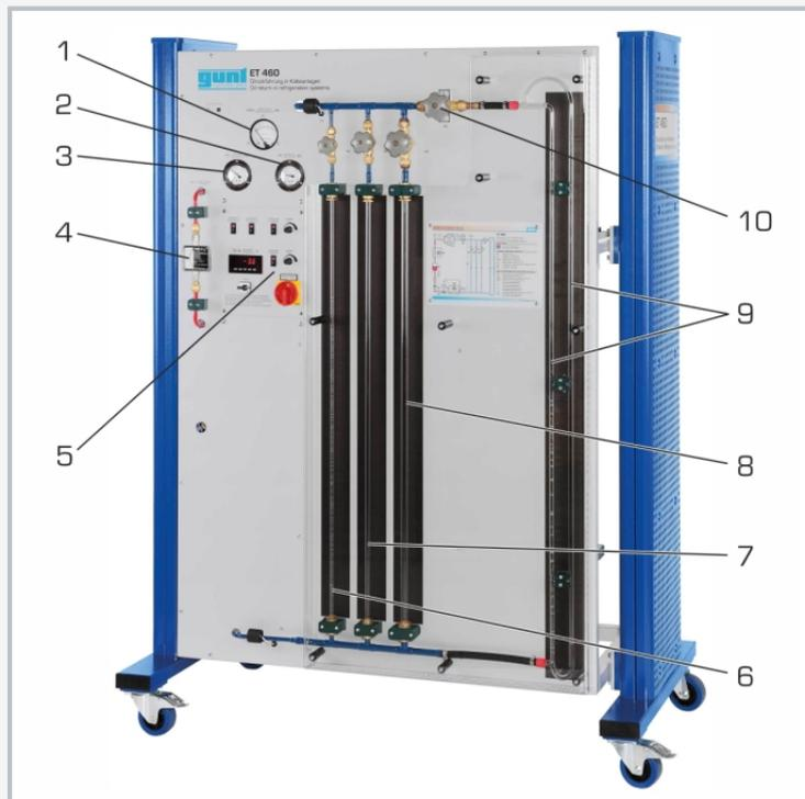
1 Manometer Differenzdruck, 2 Manometer Druckseite, 3 Manometer Saugseite, 4 Durchflussmesser, 5 Anzeige- und Bedienelemente, 6 Steigleitung  $\varnothing$  6mm, 7 Steigleitung  $\varnothing$  10mm, 8 Steigleitung  $\varnothing$  14,4mm, 9 Doppelsteigleitung, 10 Ventil zur Wahl der Steigleitung
