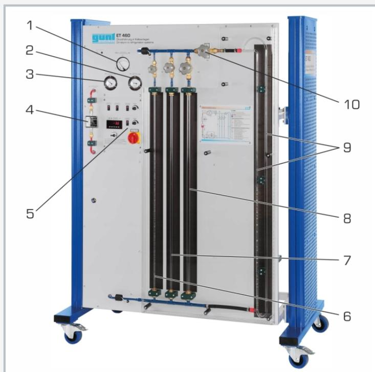
1 manomètre pression différentielle, 2 manomètre côté pression, 3 manomètre côté aspiration, 4 débitmètre, 5 éléments d'affichage et de commande, 6 conduite montante Ø 6mm, 7 conduite montante Ø 10mm, 8 conduite montante Ø 14,4mm, 9 conduite montante double, 10 vanne de choix de la conduite montante
