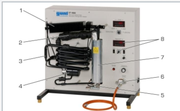
1 condenseur, 2 évaporateur avec chauffage, 3 absorbeur, 4 réservoir, 5 brûleur à gaz, 6 soupape de réduction de pression pour le fonctionnement avec propane, 7 bouilleur avec pompe pour bulles de vapeur pour l'éjection de l'ammoniac, 8 éléments d'affichage et de commande
