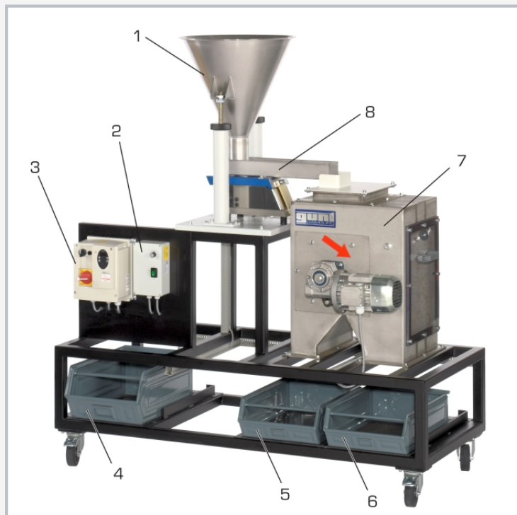
1 tolva de alimentación de altura regulable, 2 cuadro de mandos de la canaleta vibratoria, 3 cuadro de mandos del separador magnético, 4 depósito para mezcla heterogénea de materiales sólidos, 5 depósito de materiales magnetizables, 6 depósito de materiales no magnetizables, 7 separador magnético, 8 canaleta vibratoria
