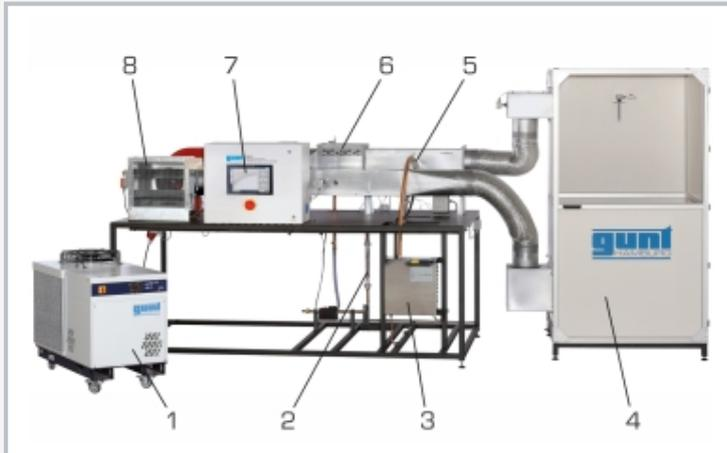
1 refroidisseur d'eau, 2 débitmètre, 3 humidificateur à vapeur, 4 chambre climatique, 5 distributeur de vapeur (humidificateur), 6 refroidisseur d'air, 7 régulateur de climatisation API, 8 entrée d'air extérieur avec ventilateur; couvert: réchauffeur d'air
