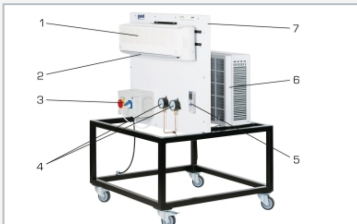
1 entrée d'air de l'unité interne, 2 sortie d'air de l'unité interne, 3 armoire de commande, 4 manomètre, 5 commande à distance, 6 unité externe, 7 cloison
