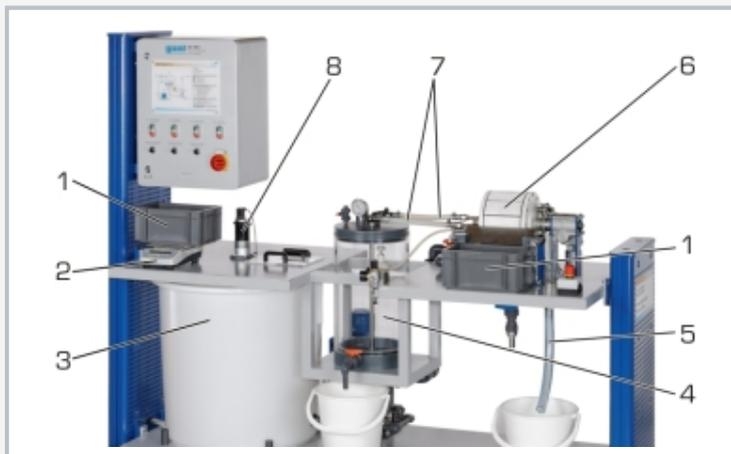
1 réservoir collecteur pour gâteau de filtre, 2 balances, 3 réservoir de réserve à suspension, 4 réservoir à dépression filtrat, 5 trop-plein/sortie, 6 filtre cellulaire à tambour, 7 raccord de dépression, 8 agitateur
