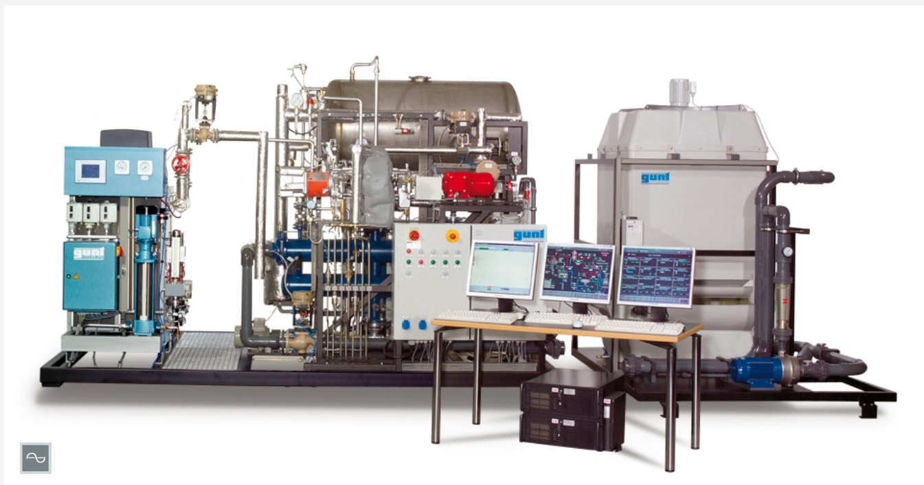
Die Abbildung zeigt das Dampfkraftwerk zusammen mit dem Kühlturm ET 833.01.
