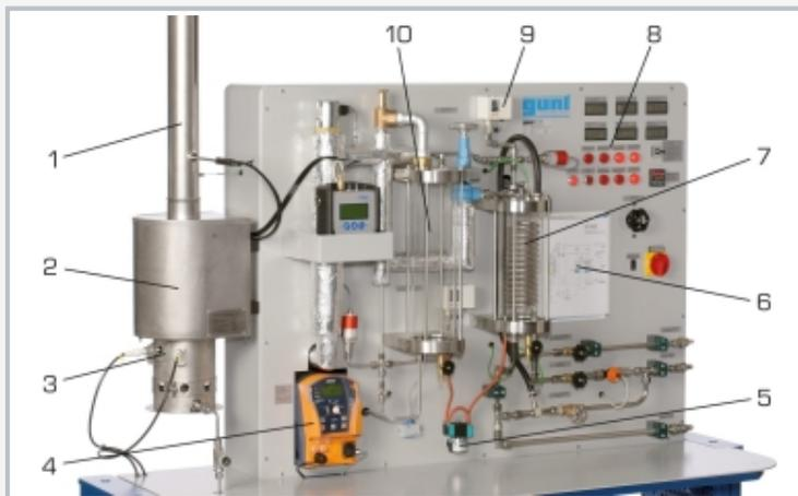
1 extracción de gases de escape, 2 generador de vapor, 3 quemador, 4 bomba de agua, 5 bomba de agua condensada, 6 esquema de proceso, 7 condensador, 8 elementos de indicación y mando, 9 interruptor manométrico, 10 depósito de agua de alimentación
