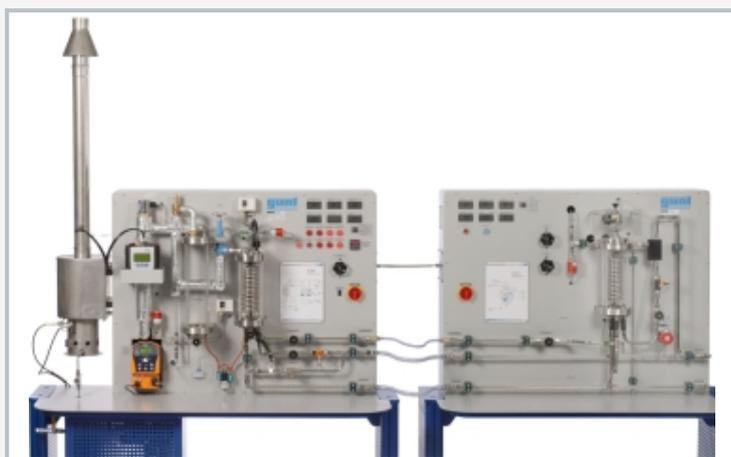
A la izquierda, el generador de vapor ET 850 y a la derecha, la turbina de vapor axial ET 851: montados listos para el funcionamiento constituyen juntos una central térmica de vapor
