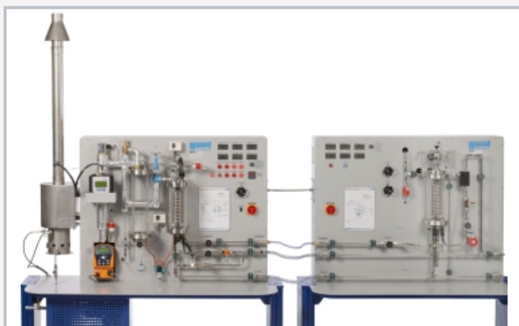
links der Dampferzeuger ET 850 und rechts die axiale Dampfturbine ET 851; betriebsbereit aufgebaut bilden beide gemeinsam eine komplette Dampfkraftanlage
