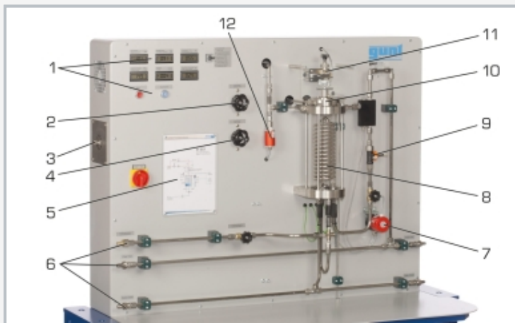
1 Anzeige- und Bedienelemente, 2 Ventil für Sperrdampf, 3 Dampfanschluss, 4 Ventil für Dampfeintritt, 5 Prozessschema, 6 Wasseranschlüsse, 7 Druckaufnehmer zur Kondensatmessung, 8 Kondensator mit Rohrschlange, 9 Durchflussaufnehmer Kühlwasser, 10 Turbine, 11 Wirbelstrombremse, 12 Druckaufnehmer
