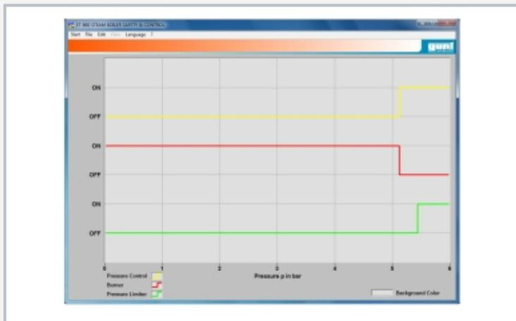
Capture d'écran du logiciel: comportement du brûleur, du limiteur de pression et du manostat en cas d'augmentation de la pression dans la chaudière
