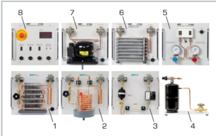
1 évaporateur chauffé par air, 2 évaporateur chauffé par eau, 3 voyant avec filtre/sécheur et débitmètre, 4 réservoir, 5 pressostat, 6 condenseur refroidi par air, 7 compresseur, 8 éléments d'affichage et de commande
