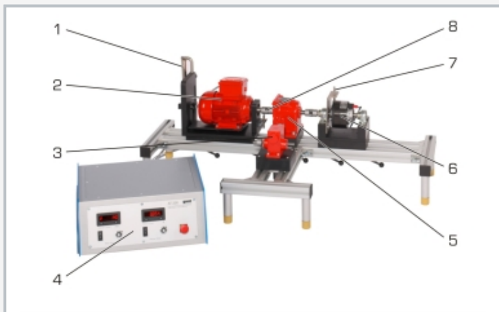
1 balance à ressort, 2 moteur, 3 engrenage à vis sans fin, 4 appareil d'affichage et de commande, 5 engrenage droit, 6 frein, 7 bras de levier du frein, 8 accouplage
