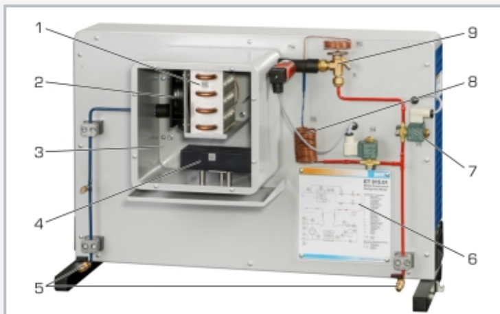
1 évaporateur, 2 ventilateur, 3 chambre de refroidissement, 4 dispositif de chauffage, 5 raccords à l'ET 915, 6 schéma de processus, 7 électrovanne, 8 tube capillaire, 9 soupape de détente
