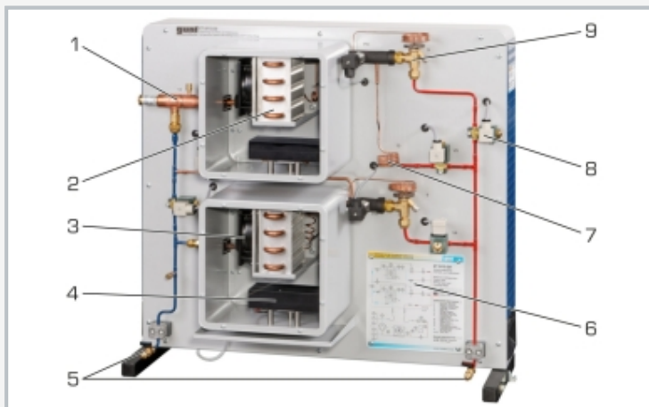
1 régulateur de pression d'évaporation, 2 évaporateur, 3 ventilateur, 4 dispositif de chauffage, 5 raccords à l'ET 915, 6 schéma de processus, 7 tube capillaire, 8 électrovanne, 9 soupape de détente
